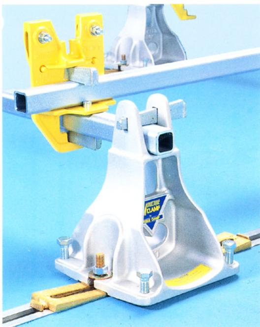
前後引きであれ、左右引きであれ、斜めや上方引きであってもロッカーパネル、ピンチウェルド部にかかる力は自動反発応用力によって(反作用力が生ずるために)クランプ部を傷めず、ほとんど補助固定を必要としません。シンプルイズベストを最終目標に10年間の実作業データをベースにして開発されたもので、アルミ合金スタンドと、大変軽量なハイテンション超高力スチールパイプを使用しているため、頑丈、コンパクトで軽く、強靱ダクタイル合金ボデークランプは、どんな車種でもジャッキポイントセンターをセットできます。ジープ車、ワンボックス、RV、ベンツ、BMW、サーブ、ホンダ車にも対応できます。
